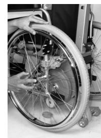
С помощью кнопки ВВЕРХ, немного приподнимите коляску, чтобы она оторвалась от земли, и снимите колеса, убрав их в сторону или установив их на крепления для транспортировки снятых колес (дополнительный аксессуар), установленных на коляске.
