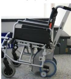
Затем с помощью кнопки ВНИЗ, верните выдвижную опору в её исходное положение, установив s-max на колеса. На этом этапе s-max готов к работе.
