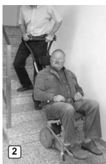
5. Расположите подъемник у самой нижней ступени, сами же поднимитесь на вторую или третью ступень. Немного наклонитесь назад, чтобы опереть на себя поперечный гриф ручки (Рис. 2). Ходовые колеса подъемного агрегата должны находиться у самой нижней ступени!
