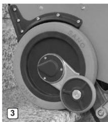
5. Постепенно перемещайте подъемник к краю ступени, тормоз автоматически остановит ходовые колеса подъемника (Рис. 3). Нажмите на переключателе рукоятки «Вверх/вниз» клавишу «Вниз».
